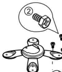
•Les vis (M4/15L) sont pour les écrans spéciaux lorsque les vis normalement fournies sont trop courtes pour la fixation.
